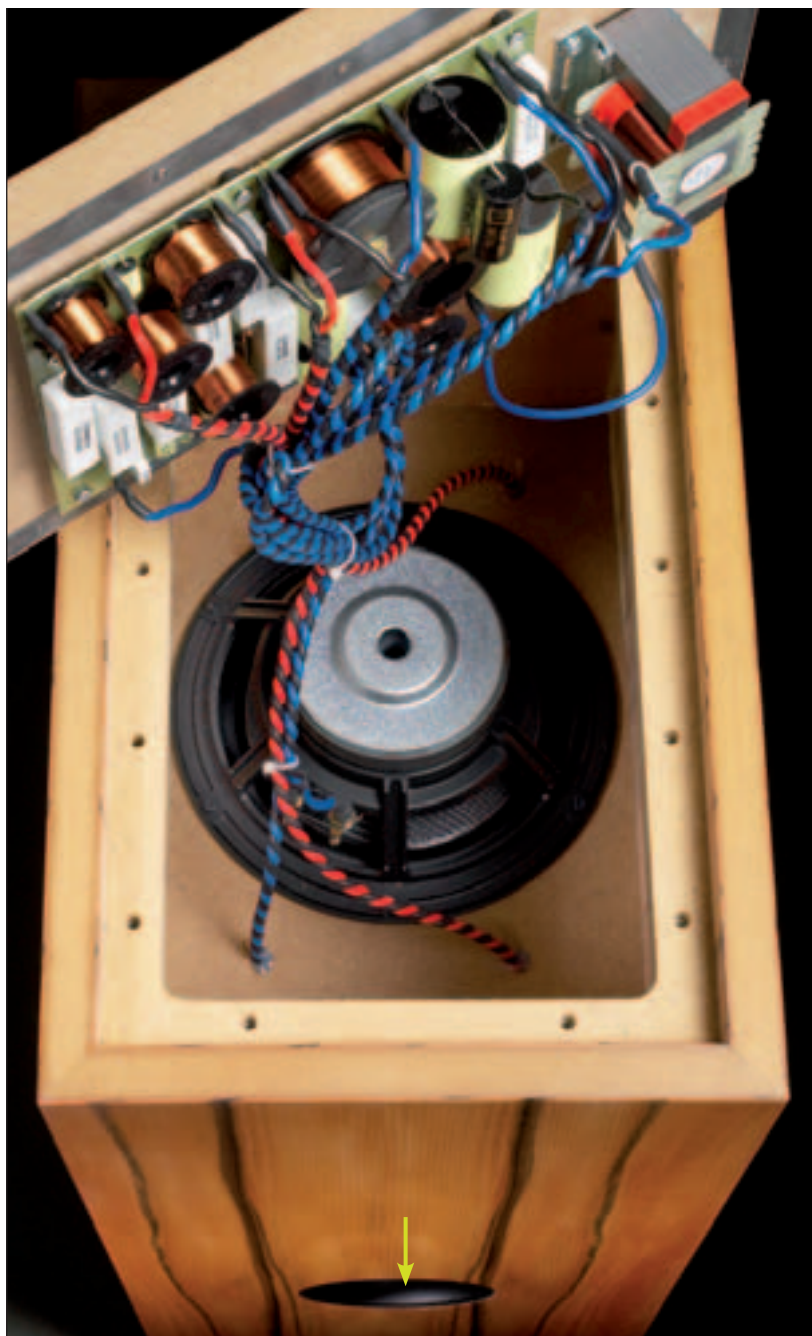
Arbeitet verdeckt: Der Bass der Ascendo schwingt zwischen zwei Kammern, über das Rohr (gelber Pfeil) dringt der Schall nach draußen.
