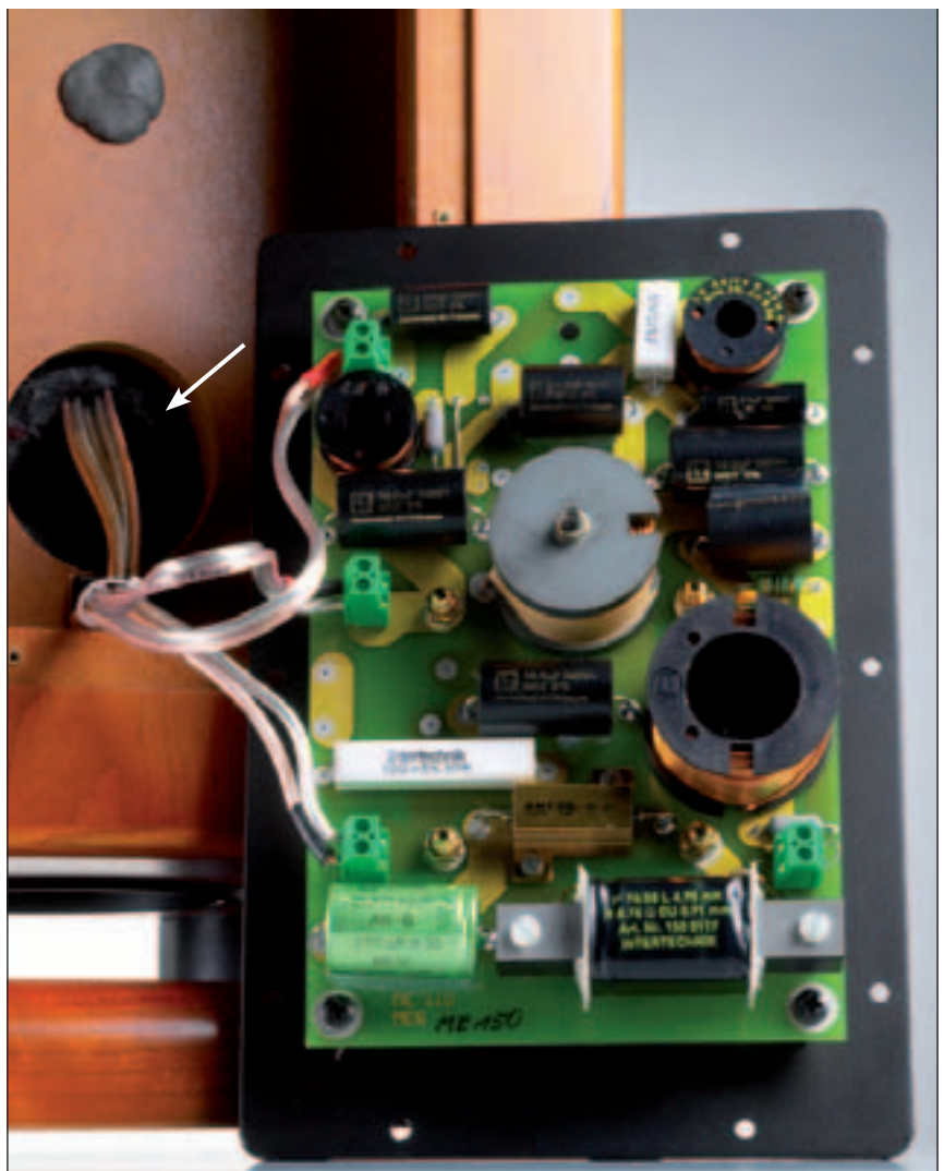
Doppelfunktion: Die Kammer hat Platz für die komplexe Frequenzweiche und dient obendrein via Resonator-Durchgang (Pfeil) als Absorber zur Resonanzbedämpfung.
